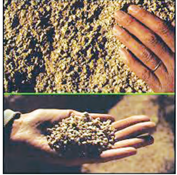
شکل ۳۴: ریزہ کاری فرسودگی
